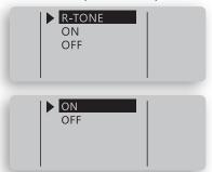
Sélectionner ON ◀ pour activer la confirmation de mesure audio.
