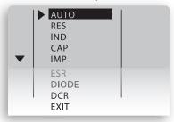
**MODE AUTO:** Sélectionner le mode AUTO (le symbole s'affiche dans le coin inférieur gauche de l'affichage) pour la mesure automatique de l'inductance, la capacité ou la résistance.
