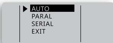
N'importe quel composant non idéal peut être représenté comme un élément résistif en série ou en parallèle avec un composant réactif. Selon les caractéristiques du composant le modèle série ou parallèle sera plus précis. Dans la plupart des cas, les pièces sont mieux estimées par le modèle de série. Les fabricants indiquent souvent que la représentation doit être utilisée lors du test de leurs appareils.
