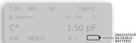
L'icône de batterie vide sur l'affichage indique que la batterie de l'appareil est faible et doit être rechargée. L'avertissement apparaît lorsque la tension de la batterie descend en dessous de 3,55V, c'est à dire que les batteries sont environ 90% déchargées. L'appareil restera opérationnel pendant une courte période, mais les batteries doivent être rechargées dès que possible
